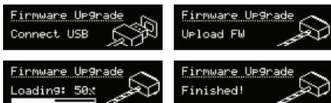
如需升级 Echolocator 的固件，请先将 Echolocator 关机并通过 USB 线连接到电脑。随后，按住 DATA 旋钮与 TAP TEMPO 旋钮的同时启动 Echolocator，此时设备会出现固件升级提示，并且电脑中会显示名为 Echolocator 的外部硬盘。
